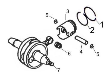
**Description APG Part No.** Part. No SP-GG100-C-01 **COMPRESSION RING A** GE1E45F-C-01 SP-GG100-C-02 **COMPRESSION RING B** GE1E45F-C-02 SP-GG100-C-03 GE1E45F-C-03 PISTON SP-GG100-C-04 **PISTON PIN** GE1E45F-C-04 SP-GG100-C-05 PISTON PIN CLIP(10mm) GE1E45F-C-05 SP-GG100-C-06 NEEDLE BEARING(φ14×φ10×13) GE1E45F-C-06 SP-GG100-C-07 **CRANKSHAFT** GE1E45F-C-07
